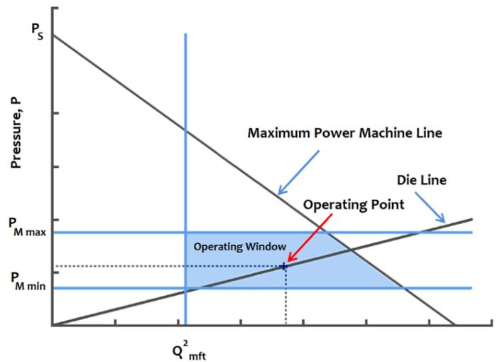
Fig. 3. PQ<sup>2</sup> Diagram [49].
